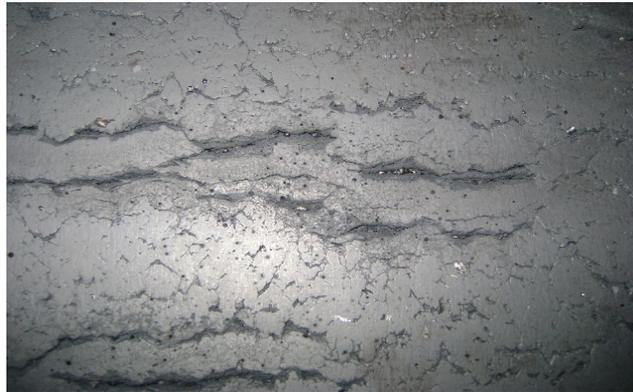
**Figura 2** – Superfície de um aço laminado a quente relação Manganês/ Enxofre Inadequada.
