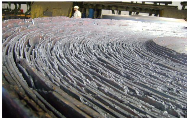
**Figura 3** – Borda de uma bobina laminada a quente com relação Manganês/ Enxofre Inadequada.
