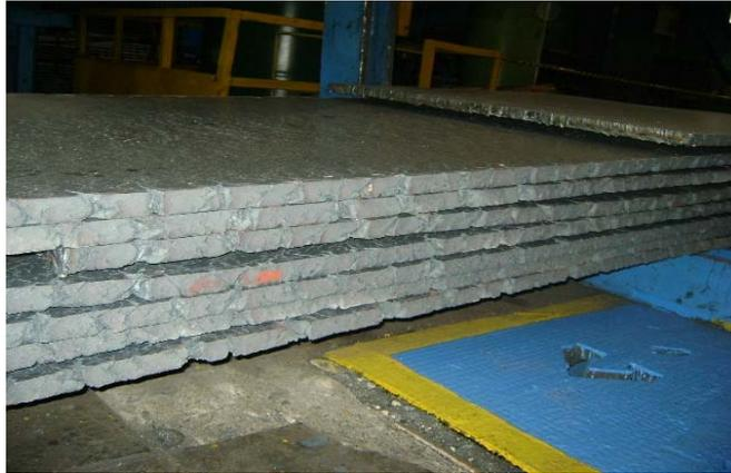
**Figura 1** – Esboço laminado com um aço com relação Manganês/ Enxofre Inadequada.
