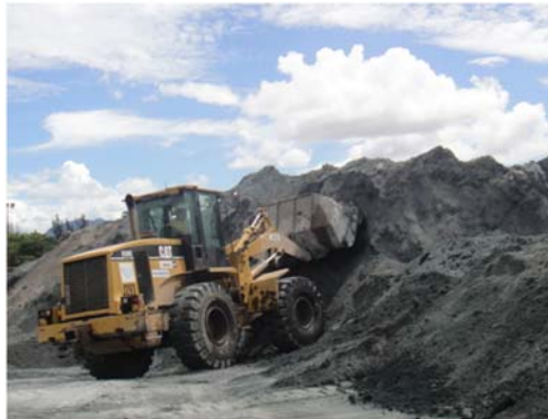
Figura 2. Coleta da Amostra de Pilha de Escória bruta com pá carregadeira.
