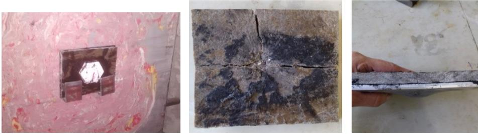
Figura 6 - Blindagem multicamada com compósito laminado de tecido de rami: (a) Antes, (b) e (c), após o impacto balístico.
