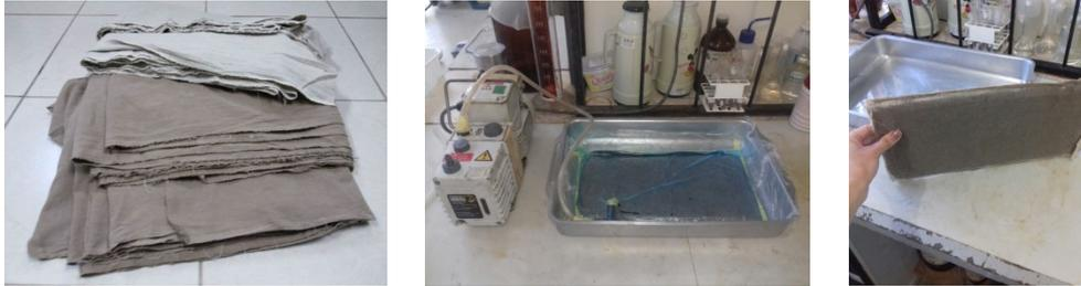
Figura 1 – (a) Tecido de Rami, (b) Molde metálico à vácuo, (c) Compósito laminado.
