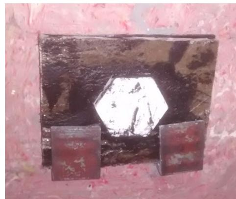
Figura 2 - Blindagem multicamada: Diagrama esquemático: A é a camada cerâmica, B é o compósito laminado, C é o alumínio e Figura 3 - Equipamento utilizado no ensaio balístico: Alvo posicionado na plastilina; (Fonte: DA SILVA, 2014b).
