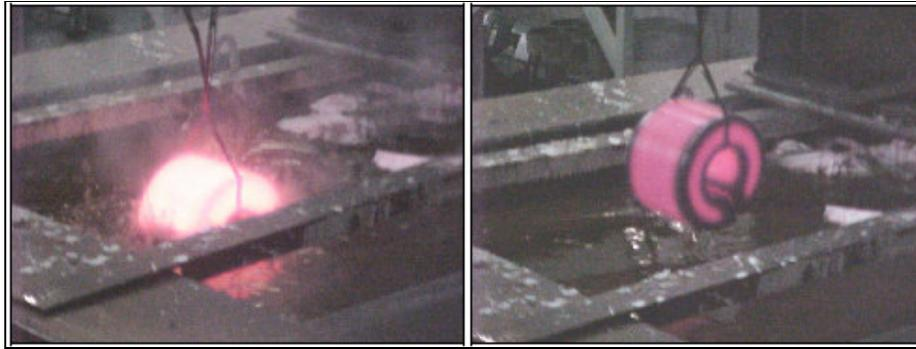
**Figura 13.** Processo de têmpera em óleo agitado e aquecido a 70°C.<sup>9/)</sup>
