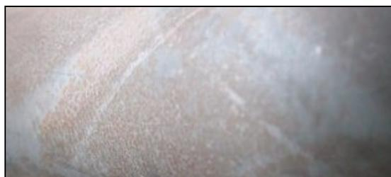
**Figura 5.** Condição superficial após tratamento térmico em banho de sal.
