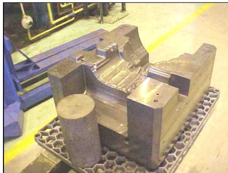
**Figura 11.** Matriz acompanhada do corpo de prova para controle de temperatura.
