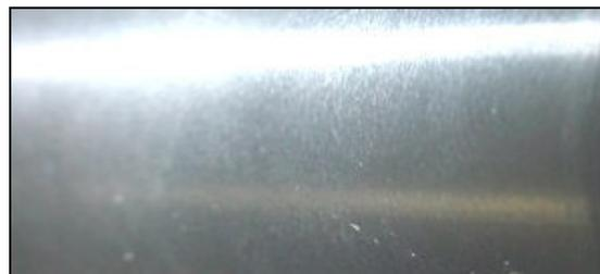
**Figura 6.** Condição superficial após tratamento térmico em forno a vácuo.
