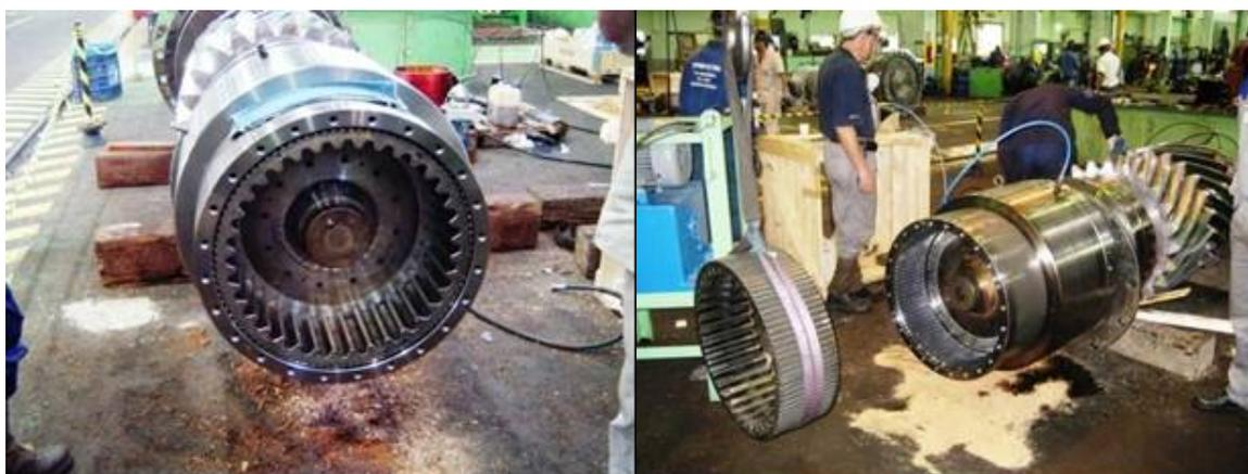
**Figura 8:** Customização do Safeset para montagem com eixo de engrenagem
