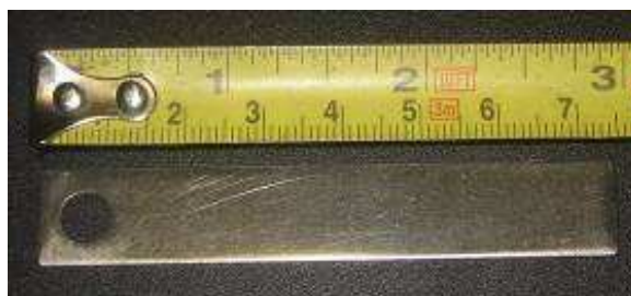
Figura 1: Cupom de prova usado para medição de taxa de corrosão.
