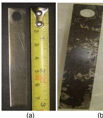
Figura 11: (a) Cupom de prova. (b) Cupom de prova apresentando corrosão generalizada
