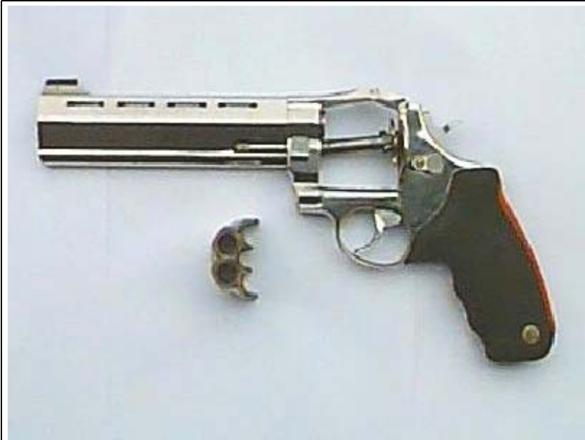
Figura 3. Revólver calibre “.454 Casull” cujo tambor explodiu; observa-se a metade encontrada do tambor fraturado (visto de topo).
