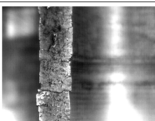
Figura 5. Pequenos pontos esféricos de coloração dourada na superfície da fratura.
