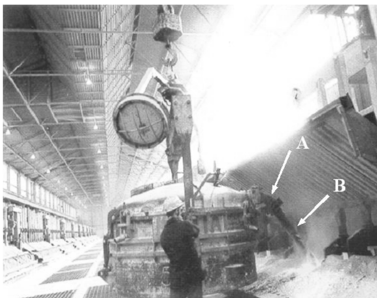
Figura 1. Sifonamento do alumínio líquido produzido na célula eletrolítica. A e B indicam as posições ao longo do sifão, de onde foram extraídas as amostras para a análise de falha do componente.
