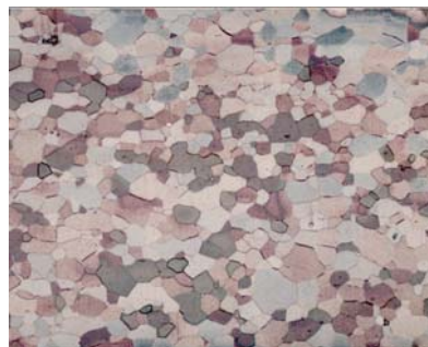
Figura 1 – Micrografia do aço IF (200x).
