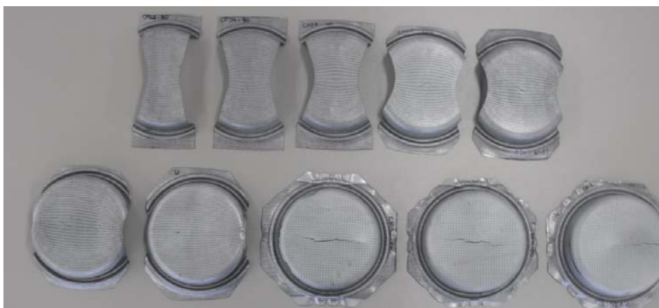
Figura 8 – Corpos de prova deformados pelo ensaio Marciniak.
