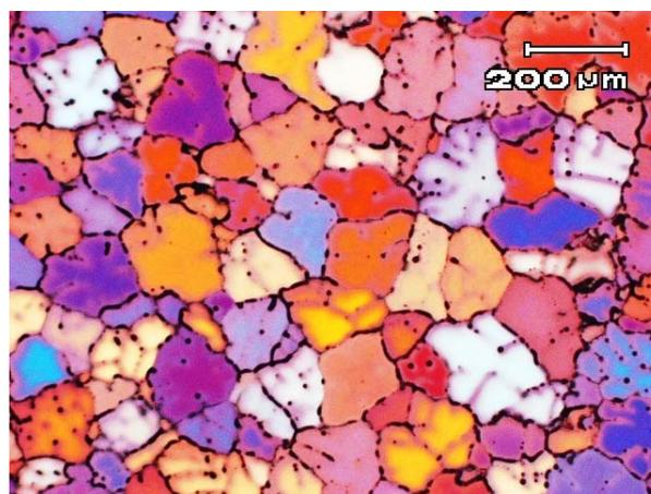
**Figura 2.** Macroestrutura do tarugo AA6351 bruta de fusão com luz polarizada. Ataque ( $HBF_4$  1,8%).
