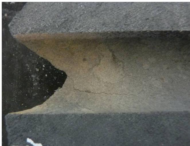
Figura 9. Fractura de barra tapón post mortem y presencia de grietas internas.
