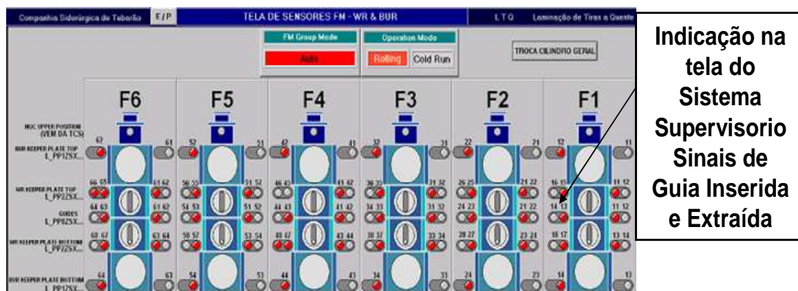
Figura 14. Tela do sistema supervisorio do Trem Acabador do LTQ da AMT.
