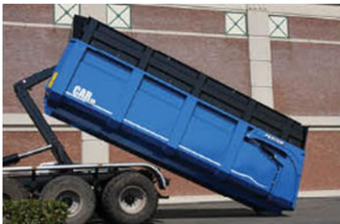
Figura 2 – Caçamba basculante removível.
