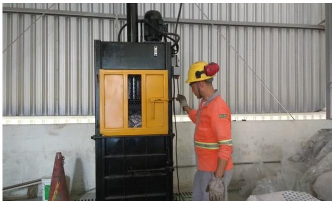
Figura 1 – Prensa hidráulica para compactação de plástico e papelão.
