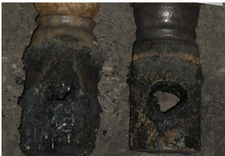
Figura 14. Redução de acúmulo de clogging devido à injeção de argônio.
