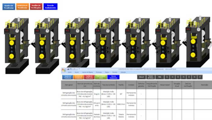
Figura 13. Ambiente de trabalho do controle do caminho da tira do trem acabador incluindo planilha de controle dos cilindros de encosto da cadeira F2.
