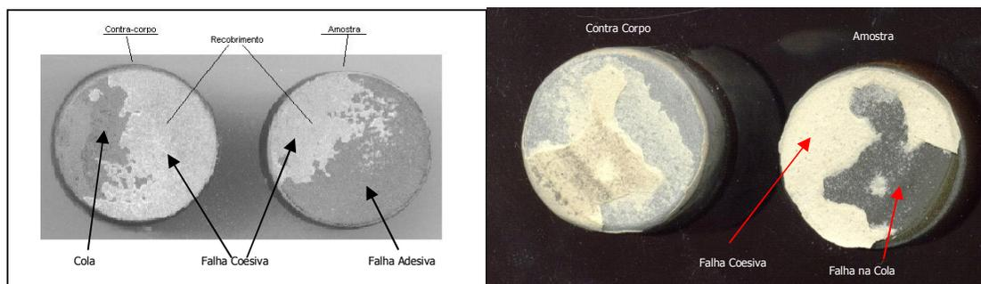
Figuras 08 e 09 – Falha mista em amostra de HA (esquerda) e em uma amostra de HAZr (direita).
