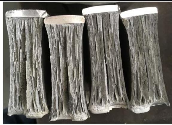
Figura 19: Corpo de prova de DWTT fraturado oriundo do ciclo 4.
