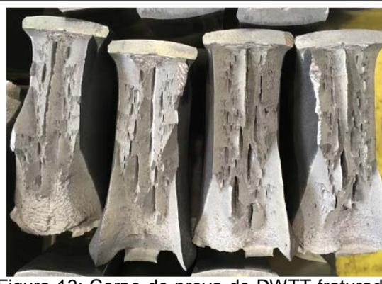
Figura 13: Corpo de prova de DWTT fraturado oriundo do ciclo 1.
