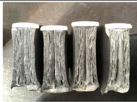
Figura 17: Corpo de prova de DWTT fraturado oriundo do ciclo 3.
