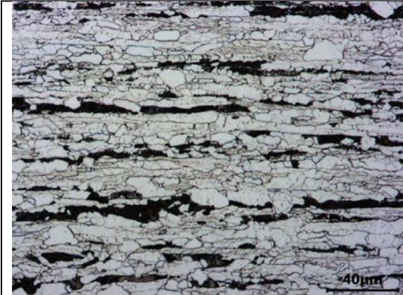
Figura 18: Microestrutura resultante do ciclo 4. Amostra a  $\frac{1}{4}$  da espessura. Aumento de 500x.
