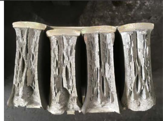
Figura 15: Corpo de prova de DWTT fraturado oriundo do ciclo 2.
