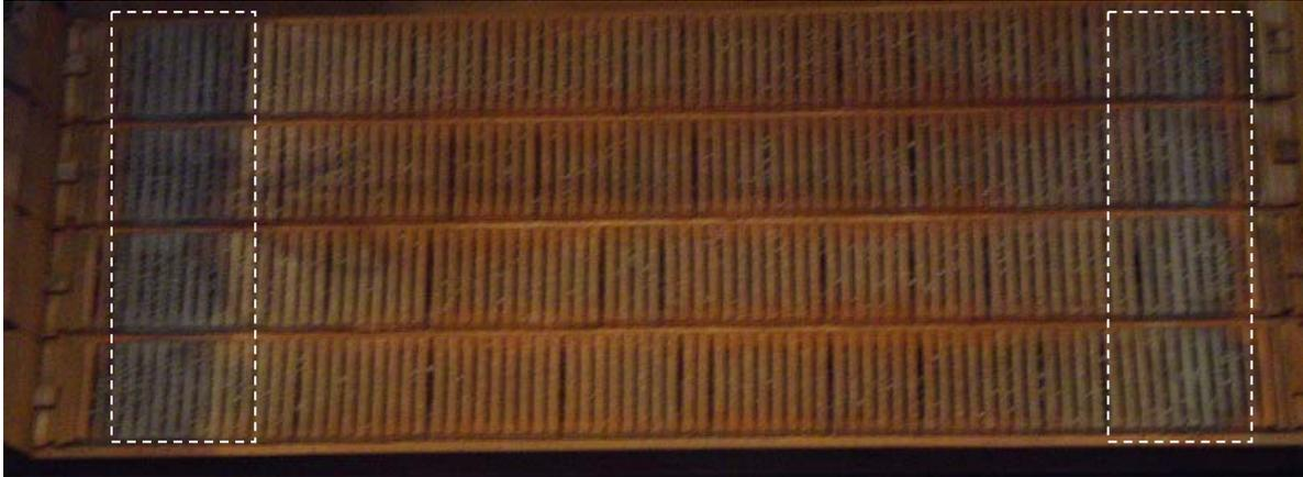
**Figura 6.** Desgaste abrasivo devido ao intenso fluxo na região.
