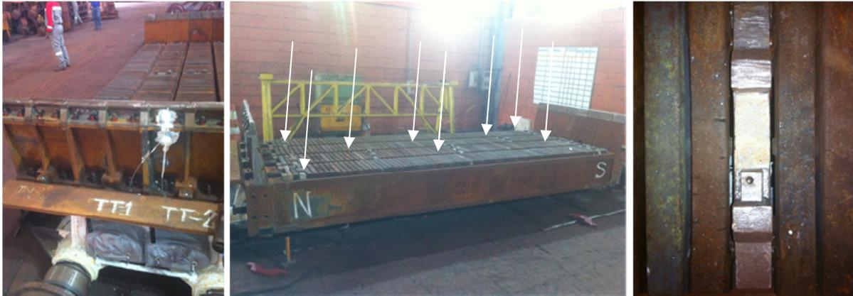
**Figura 2.** Detalhe do carro de grelha mostrado em destaque (a) Posicionamento dos transmissores de temperatura (b) vista geral do carro de grelha e posição das medidas (c) barra grelha com termopar exposto.
