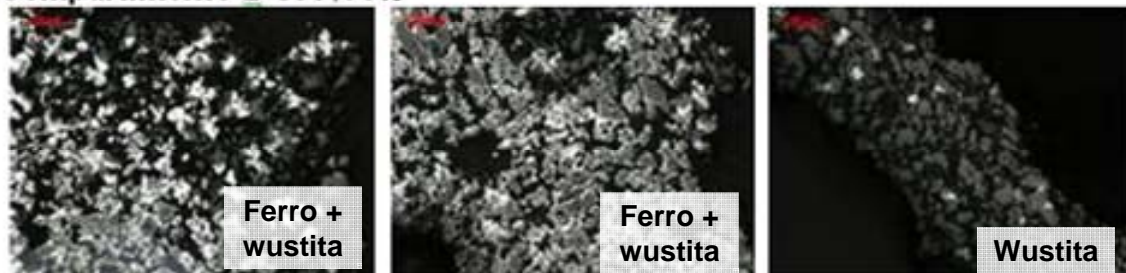
Figura 4. Menores inchamentos com 30 minutos. MO - Magnificação: 100x.
