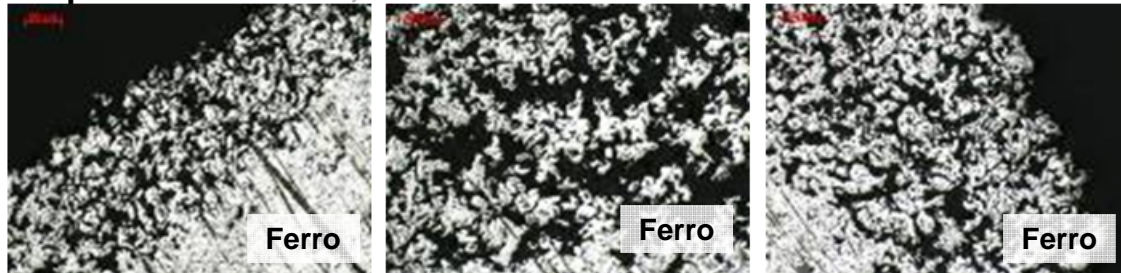
Figura 7. Menores inchamentos com 90 minutos. MO - Magnificação: 100x.
