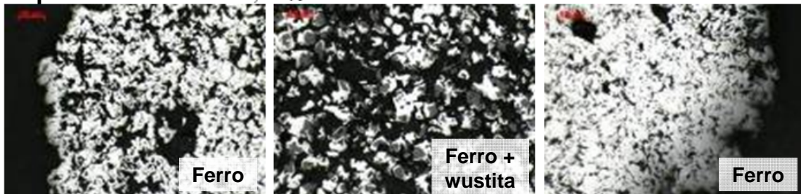
Figura 9. Maiores inchamentos com 90 minutos. MO - Magnificação: 100x.
