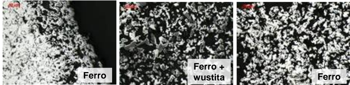
Figura 8. Médios inchamentos com 90 minutos. MO - Magnificação: 100x.
