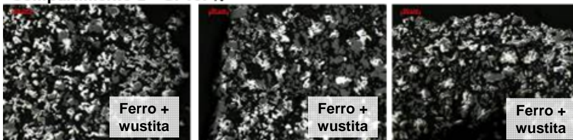
Figura 6. Maiores inchamentos com 30 minutos. MO - Magnificação: 100x.
