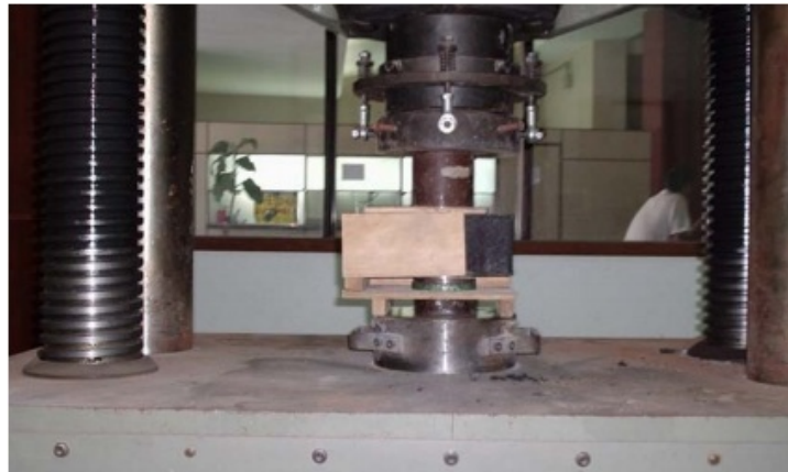
Figura 6. Prensa hidráulica utilizada nos testes de resistência à compressão. (7)
