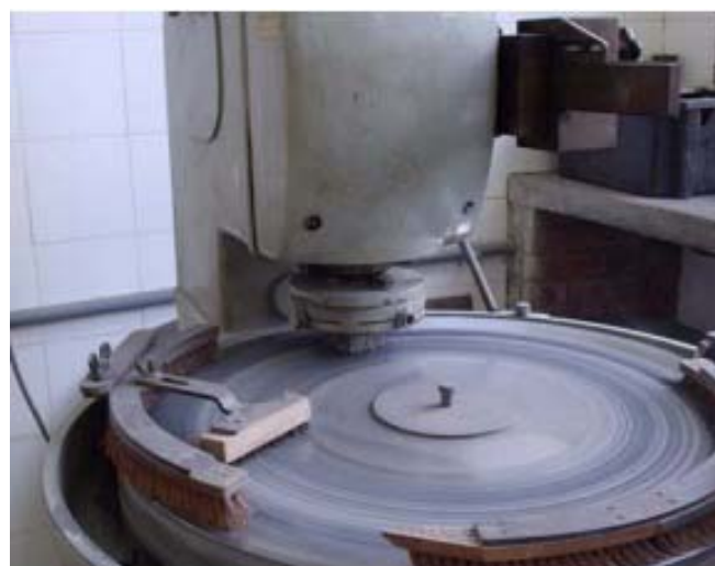
Figura 7. Máquina de testes de abrasão. (7)
