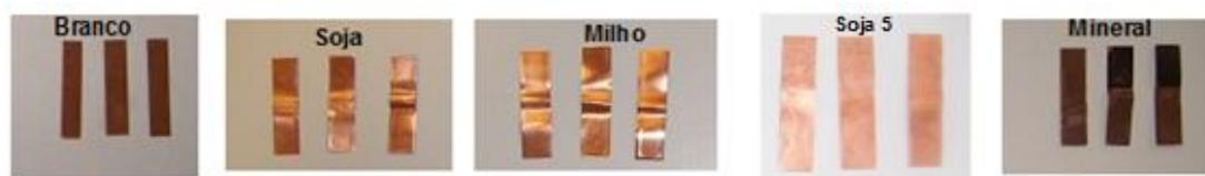
Figura 6. Lâminas de cobre obtidas na análise de corrosão.
