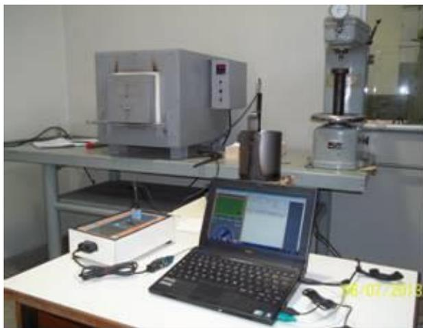
Figura 2. Interface para análise de curva de resfriamento.
