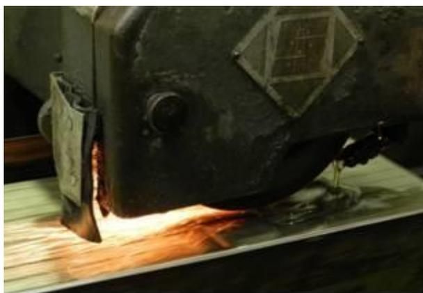
Figura 1. Retificação utilizando fluido vegetal.
