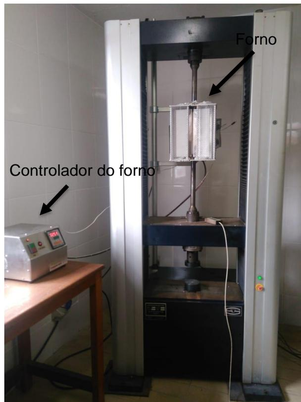
**Figura 1.** Fotografia do forno Resistivo acoplado à máquina universal de ensaios.
