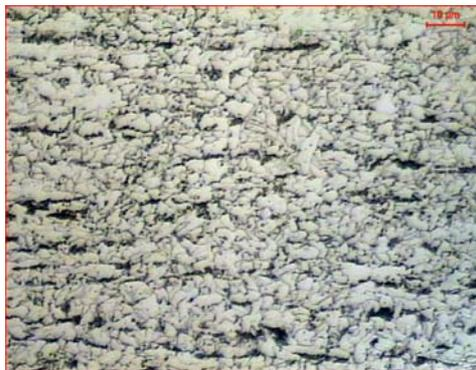
**Figura 4** – Aço ferrita-bainita. Aumento 1000X – ataque Nital 2% - seção transversal
