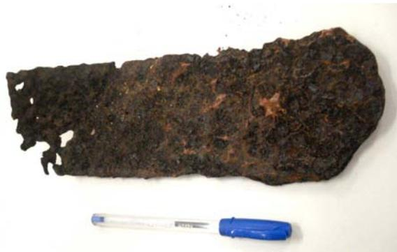
Figura 23 – Corrosão uniforme em chapa de aço inoxidável austenítico AISI 304, em meio amoniacal.
