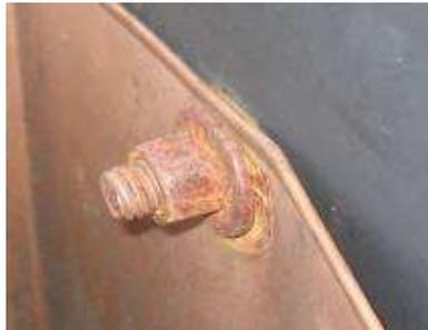
**Figura 15** – Corrosão galvânica em parafuso de aço ao carbono em contato com alumínio.
