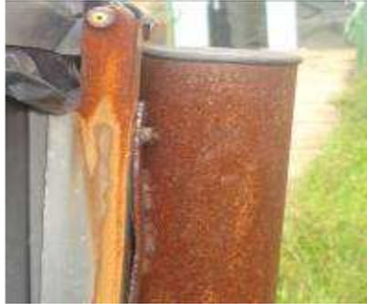
**Figura 14** – Corrosão uniforme e em fresta no suporte de uma lixeira e galvânica na base de segurança.
