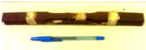
**Figura 20** – Corrosão em CPs para ensaios de tração e flexão de aço ao silício.
