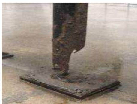
**Figura 12** – Corrosão uniforme em aço ao carbono (metalon) na base do box de um banheiro da UFOP.
