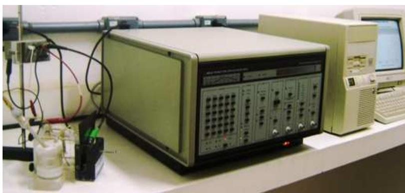
**Figura 1** – Sistema referente ao conjunto de aparelhos e acessórios para realização de ensaios de polarização potenciodinâmica.
