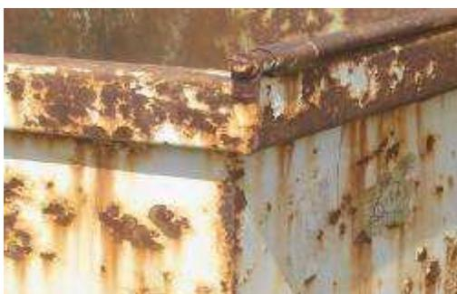
**Figura 11** – Corrosão uniforme em aço ao carbono em uma lixeira da UFOP.
