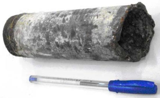
Figura 22 – Corrosão microbiológica em tubo de aço ao carbono.
