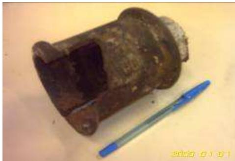
**Figura 19** – Corrosão uniforme em tubulação de ferro fundido.
