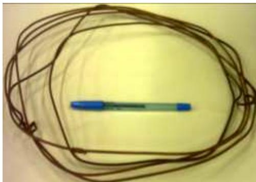
**Figura 21** – Corrosão uniforme em arame galvanizado.
