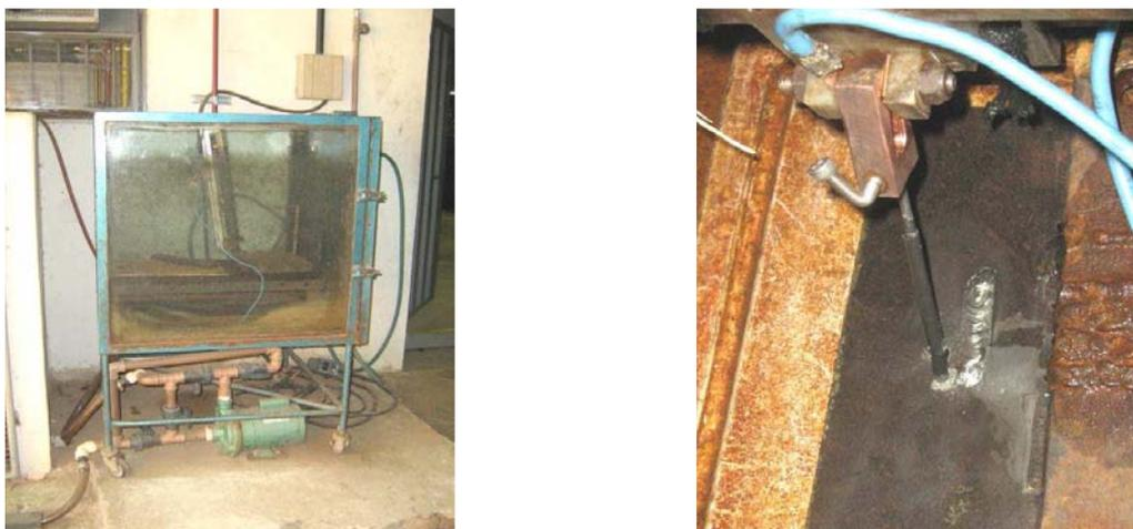
Figura 2. Sistema de soldagem por gravidade.
