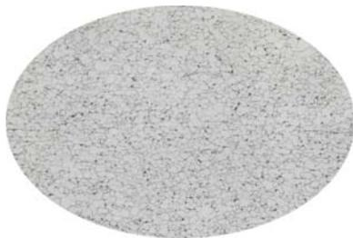
Foto 5 - Microestrutura Característica das amostras 1 a 12 - 200X – TG 11 ASTM
