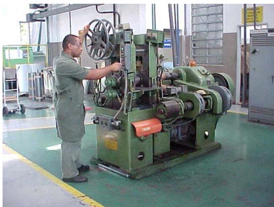
Foto 3 – Laminador a Frio Piloto utilizado na Simulação
