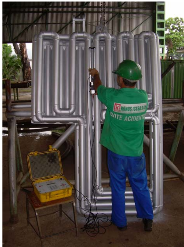
Figura 7: Medição de Vazão
