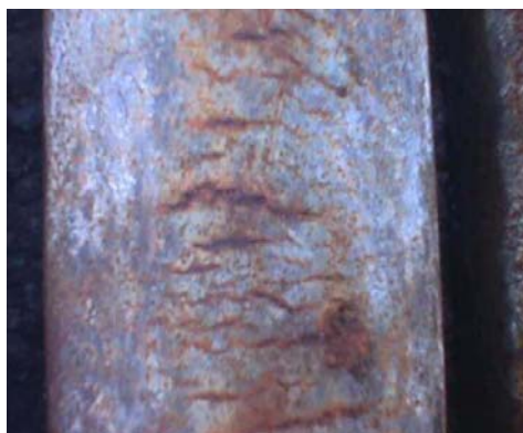
Figura 5: Processo de Fadiga Térmica em um tubo de aço carbono
