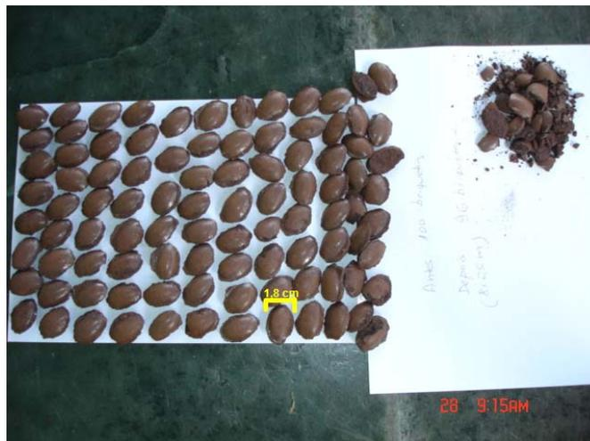
**Figura 4:** Briquetes após ensaio de queda (em folha A4).
