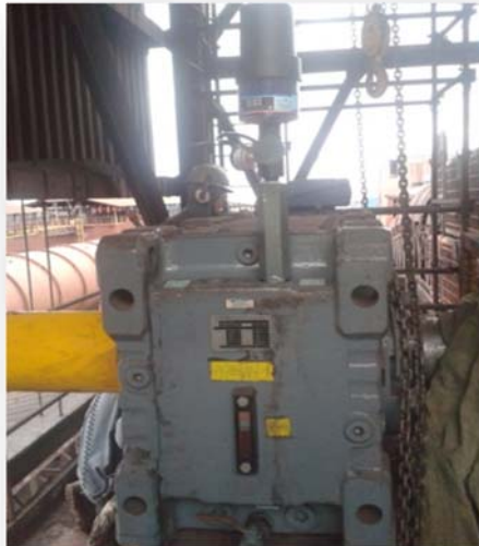
Figuras 26. Proteção do dreno e redutor com respiro e visor de coluna
