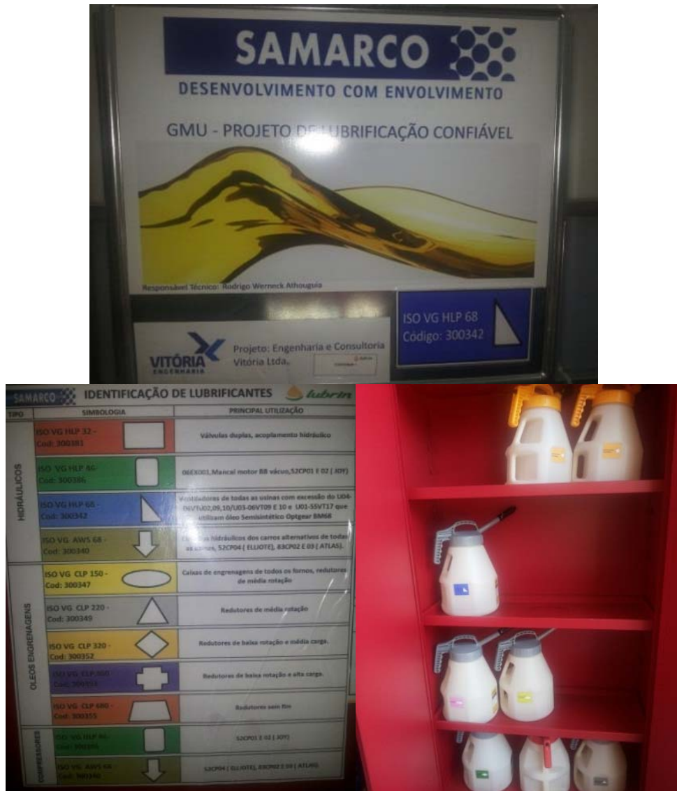
Figura 23. Identificação dos containers, dispositivos oilsafe para recebimento de óleo e simbologia para identificação dos lubrificantes.
