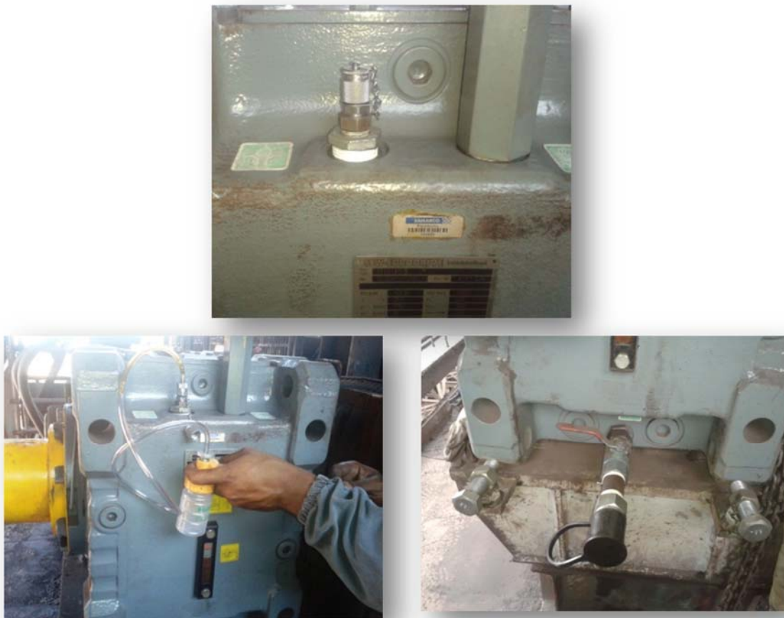
Figura 25. Dispositivo minimess e coleta do óleo pelo dispositivo.
