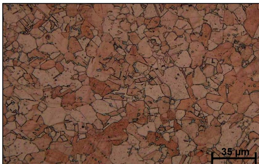
**Figura 1.** Microestrutura da liga Cu-Sn-Bi por microscopia ótica, com  $\text{FeCl}_3$  e HCl em etanol.
