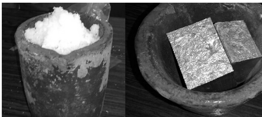
Figura 3 – Carga metálica e salina em cadinho de carbetto de silício, AUTOR.
