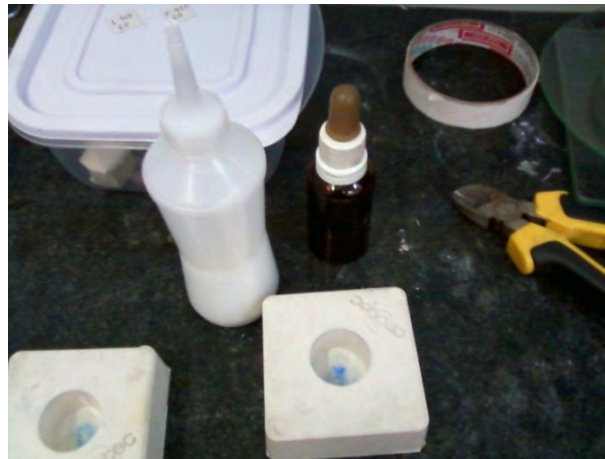
Figura 4. Etapa de embutimento.
