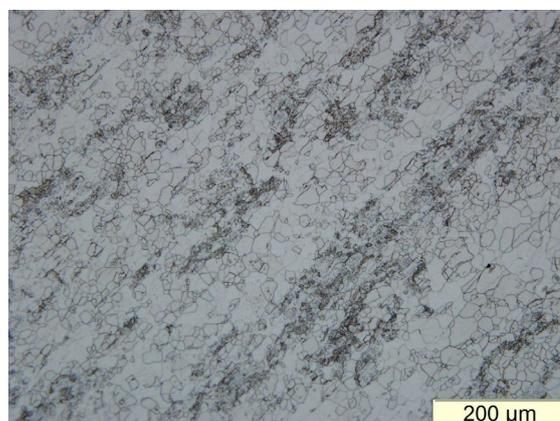
Figura 1 - Microestrutura da amostra de aço inoxidável 430, como recebida (CR).
