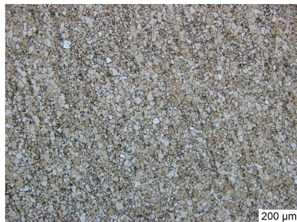
Figura 4 - Microestrutura da amostra de aço inoxidável 430, com 2 h de recozimento a 1000°C.
