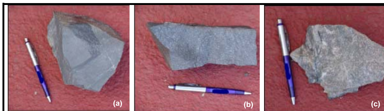
Figura 1. Macrografias das rochas de minério de manganês de Morro da Mina (a) minério de primeira; (b) minério de segunda; e (c) minério de terceira).
