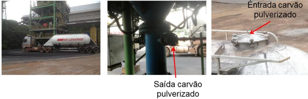
Figura 6. Carregamento de carvão pulverizado no caminhão tanque para transporte e injeção
