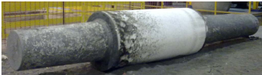
Figura 6- Cilindro rougher de aço rápido fundido na centrifuga vertical com mesa de diâmetro 960 mm e 2200 mm de comprimento.
