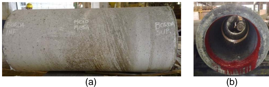
Figura 3- Tubo de aço rápido fundido na centrifuga vertical com diâmetro de 960 mm e 2200 mm de comprimento. (a) vista lateral; (b) vista frontal.
