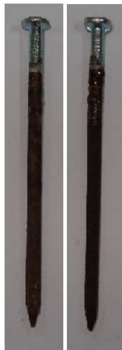
Figura 11 Aspecto dos pregos após imersão em licor da madeira cedrinho. Esquerda prego AC. Direita prego BC.
