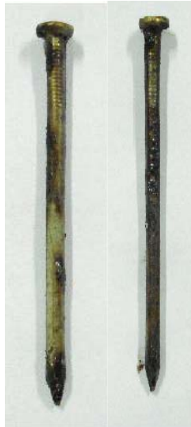
Figura 18 Exemplo do aspecto do prego BC simulando fresta na madeira grápia (esquerda) e do aspecto do mesmo prego em contato com a solução aquosa com 0,5% de NaCl .
