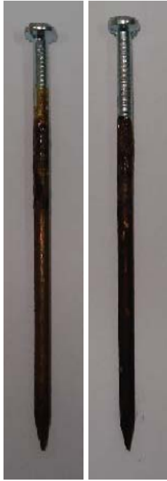
Figura 12 Aspecto dos pregos após imersão em licor da madeira grápia. Esquerda prego AC. Direita prego BC.
