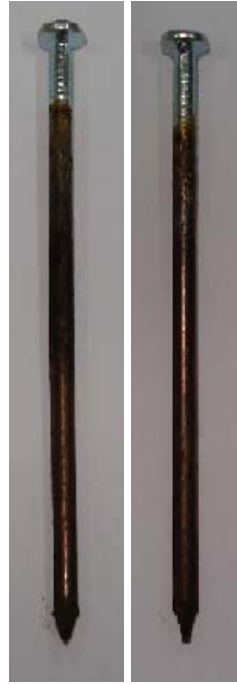
Figura 14 Aspecto dos pregos após imersão em licor da madeira itaúba. Esquerda prego AC. Direita prego BC.
