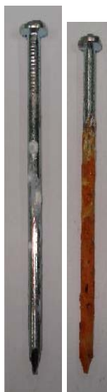
Figura 9 Aspecto dos pregos após imersão em água bidestilada. Esquerda prego AC, Direita prego BC.
