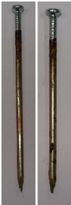
Figura 13 Aspecto dos pregos após imersão em licor da madeira ipê. Esquerda prego AC. Direita prego BC.
