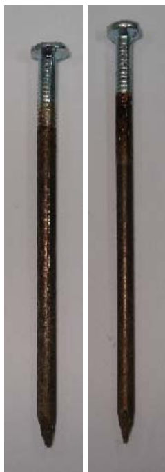
Figura 10 Aspecto dos pregos após imersão em licor da madeira cambará. Esquerda prego AC. Direita prego BC.
