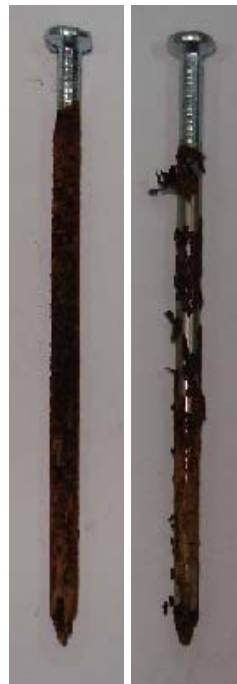
Figura 15 Aspecto dos pregos após imersão em licor da madeira clara. Esquerda prego AC. Direita prego BC.
