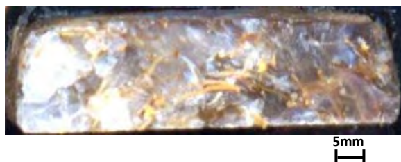
Figura 8. Análise de microscopia estereoscópica da região fraturada do compósito.
