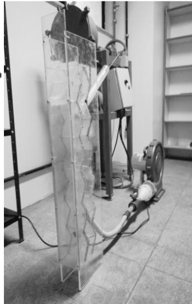
**Figura 1.** Esquema simplificado do Classificador Zig-Zag (adaptado do modelo da USBM - United States Bureau of mines),<sup>(24,25)</sup> utilizado para concentrar os metais presentes nas PCI's.
