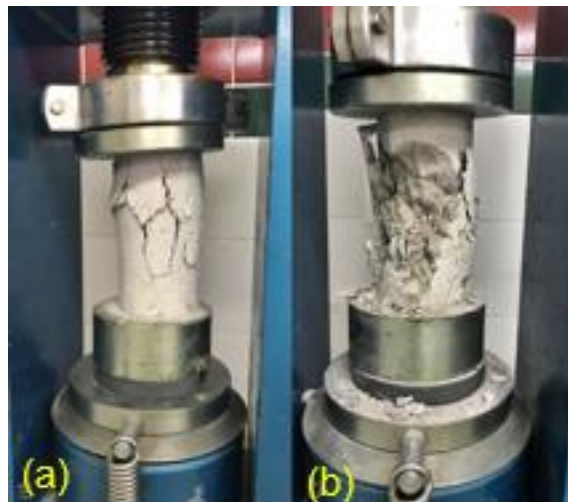
Figura 3. Corpo de prova reforçado com fibras após o rompimento (a) e corpo de prova de concreto convencional após o rompimento (b)
