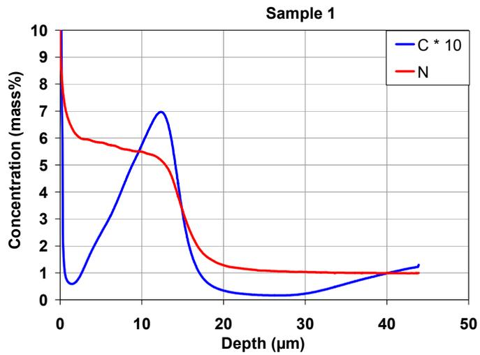
**Figura 4.** Análise via GDOS do perfil de composição química da amostra 1.
