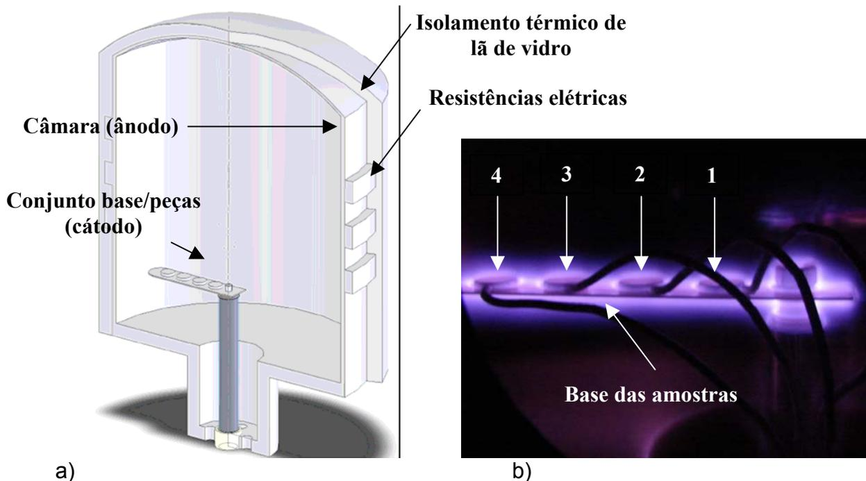
**Figura 1** - a) Desenho esquemático da câmara de nitretação, b) posicionamento das amostras no forno.
