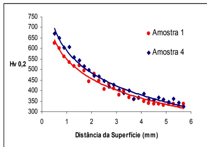
Figura 7: Diferenças no perfil de microdurezas das amostras 1 e 4.
