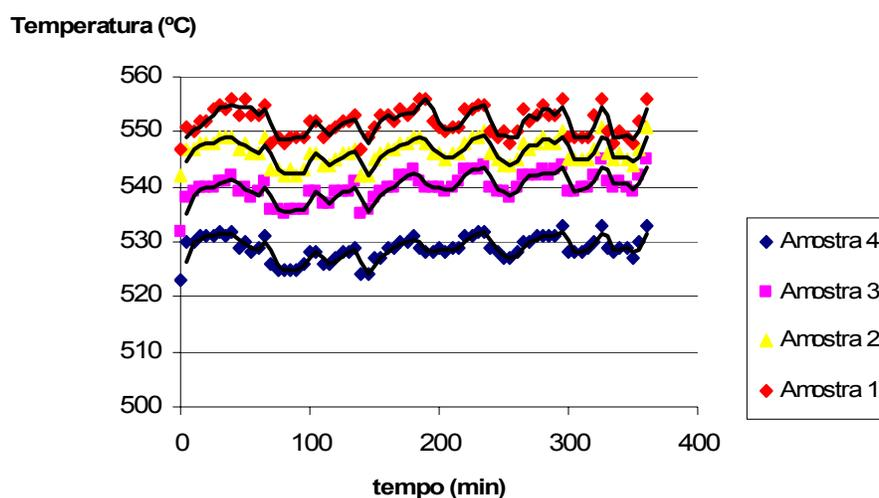
**Figura 2.** Temperatura das amostras ao longo do tempo de nitretação
