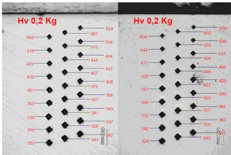
Figura 6: Identações de microdureza. A) amostra 1 e b) amostra 4.
