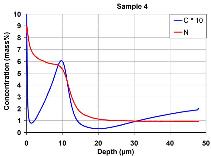
**Figura 5.** Análise via GDOS do perfil de composição química da amostra 4.
