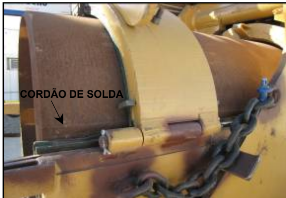
Figura 3 e 4. Cordão de solda à 90° (esquerda) e marcações feitas ao longo do tubo (direita).
