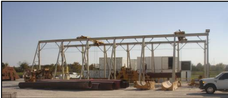
Figura 2. Facilidade para a realização de testes de curvamento.
