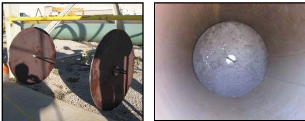
Figura 10. Placa calibradora (foto à esquerda) e passagem da placa calibradora (foto à direita).
