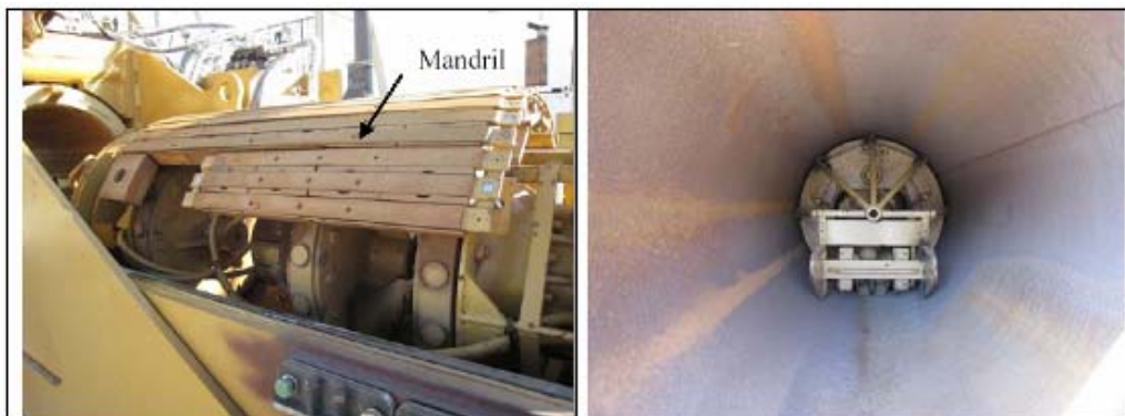
Figura 5 - Mandril empregado durante o curvamento.
