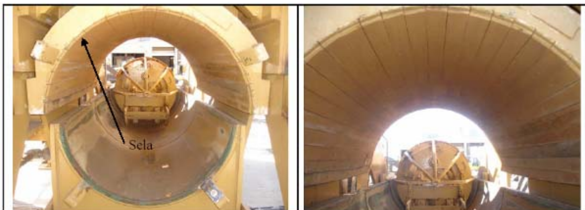
Figura 6 – Sela da curvadeira, onde ocorre a deformação do tubo.
