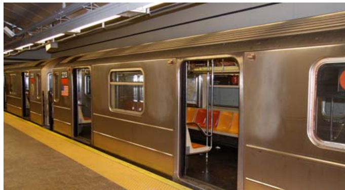
Figura 6 – Composição de metrô produzida com aço 301LN Aperam South America .
