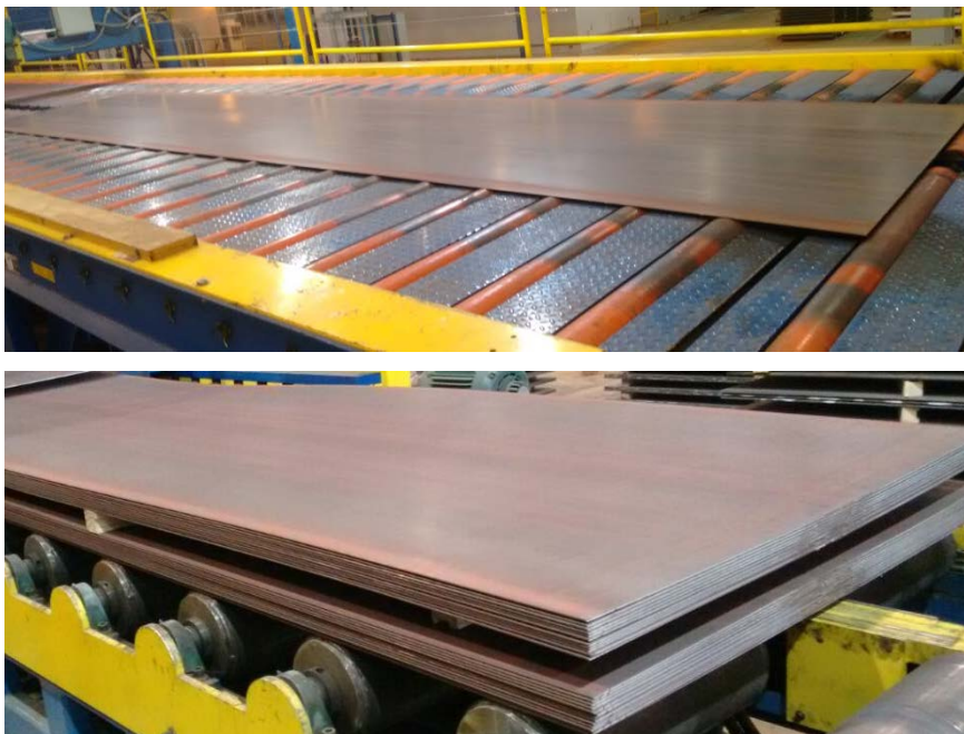
Figura 11. Aspecto de chapas do aço USILN900 após corte transversal.
