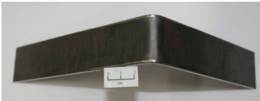
Figura 7. Aspecto de corpo de prova de aço USILN900 após ensaio de dobramento.
