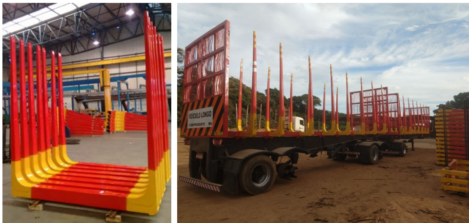
Figura 1. Exemplo da aplicação do aço de alta resistência da classe de 900 MPa de limite de escoamento.
