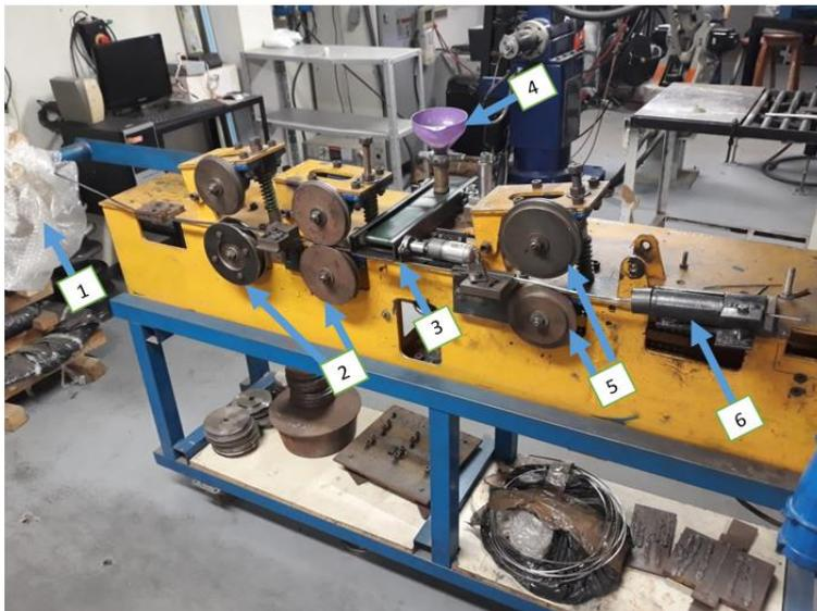
**Figura 2.** Equipamento utilizado para a produção do arame tubular. (1) bobina com a fita metálica que será conformada em arame (2) roletes de conformação da fita em um perfil de canaleta em "U" (3) esteira que transporta o fluxo até a fita (4) silo que estoca o fluxo que será depositado na esteira (5) roletes de fechamento que conformam a canaleta em tubo (6) suporte para as fieiras
