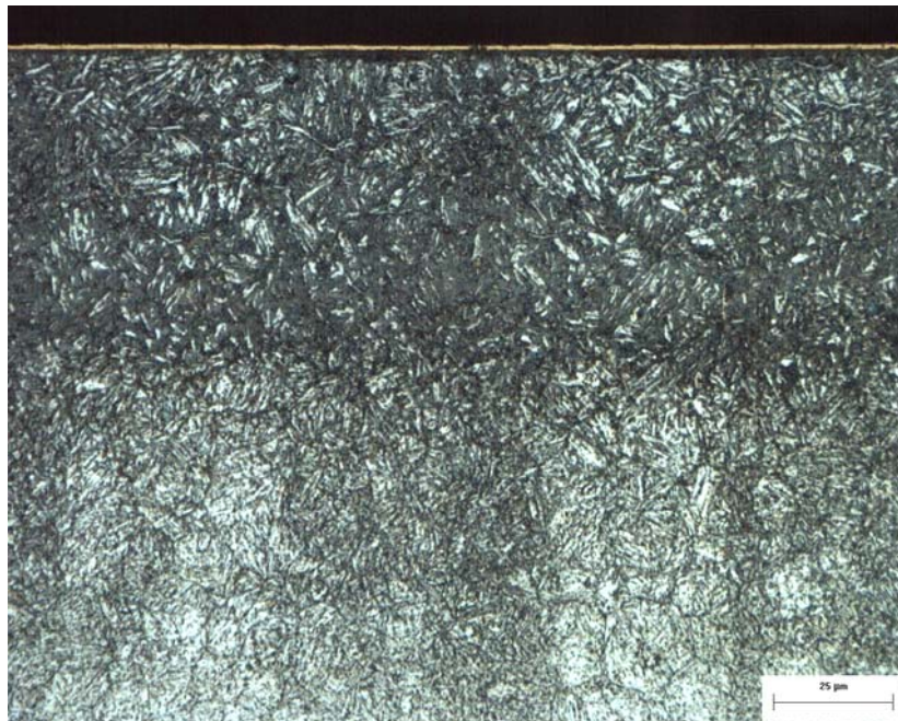
Figura 2. Estrutura da camada duplex obtida a partir da nitretação a 540°C por 2 horas, com etapa de difusão a 550°C por 8 horas. Aumento: 1000X. Ataque: Nital 4%.
