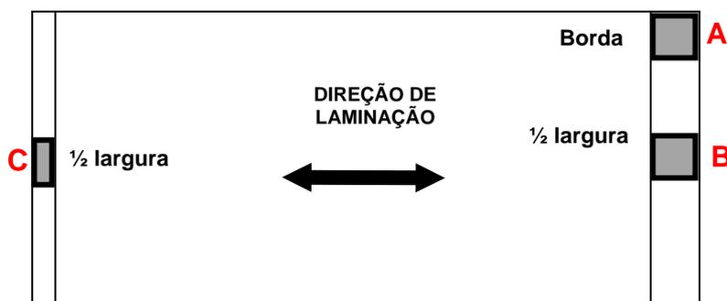
**Figura 4.** Esquema de amostragem realizado nas chapas.
