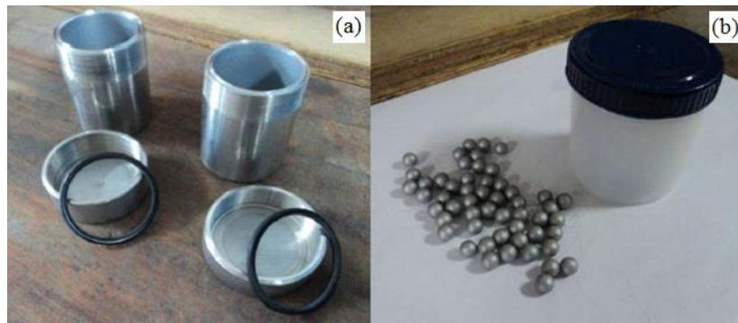
**Figura 2.** Meio de moagem. (a) Jarras de aço inox. (b) Esferas de aço inox
