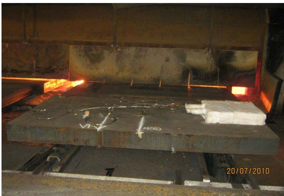
Figura 4. Fotografia da placa instrumentada prestes a ser enfiada.
