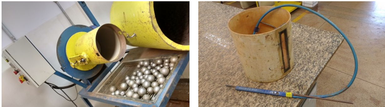
Figura 3 – a) Foto do moinho de bolas 12 pol. x12 pol., em rotação de 70% da velocidade crítica, e da carga de bolas escalonada e contendo top size de 30mm – estes foram utilizados nos ensaios laboratoriais de cominuição. b) Foto da cuba cilíndrica de 5L de volume total e da mangueira de sifonamento – estes foram utilizados nos ensaios laboratoriais de deslamagem.
