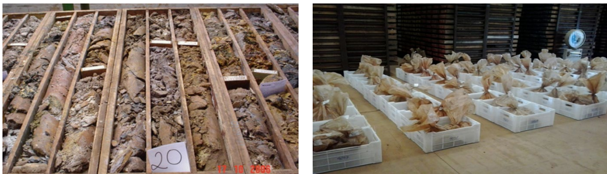
Figura 2 – a) Foto ilustrativa de caixas de furos de sonda onde são armazenadas parte das amostras retiradas das minas de Alegria Norte e Alegria Sul – amostras armazenadas em Galpão de Testemunho; b) Foto ilustrativa de amostras reservas de furos de sonda [massas não processadas nos ensaios de caracterização] e que foram utilizadas para a realização deste estudo.
